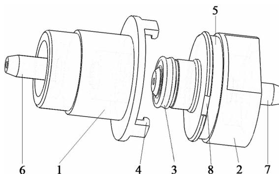
1. 一种生物反应器用微型旋转密封,包括密封体和密封圈,其特征在于,所述密封体包括中空的密封壳体和密封轴芯,所述密封圈为 x 型硅橡胶密封圈,所述密封壳体和密封轴芯上均设置有管路接头,所述密封壳体的一端设置有三个止退卡,所述密封轴芯上设置有环形卡槽,所述环形卡槽上有所述止退卡对应的豁口;所述密封圈套在密封轴芯远离管路接头的一端,所述密封壳体通过所述止退卡套在所述密封轴芯的环形卡槽上,以防止密封壳体与轴芯分离;所述密封体的内部设置有供气体或是液体的流体通过的孔,孔的孔径为 1mm;所述密封壳体采用聚碳酸酯材料,密封轴心采用聚四氟乙烯材料。
