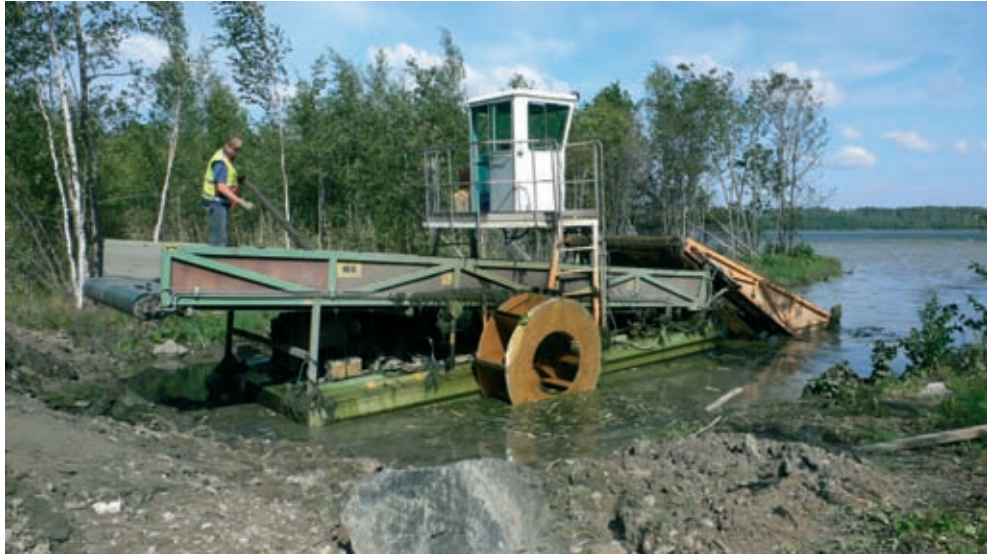
Kuva 22. Karvalehden poistoa keräävällä harvesterilla Espoon Matalajärvellä elokuussa 2006. Kuva: Milla Laita
