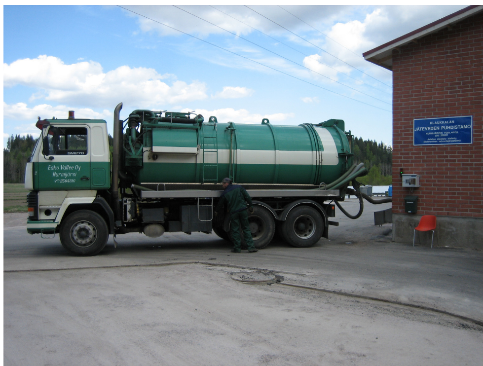
Kuva 8. Saostuskaivolietteen vastaanotto Klaukkalan jätevedenpuhdistamolla.
