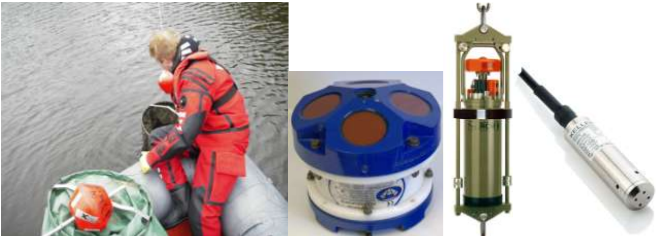
Kuvat 5a-d. Lieriöuimureita (a, vasen), ADCP-virtausmittari (b), RCM9-virtausmittari (c) sekä paineanturi (d) vedenkorkeuden mittaamista varten.
