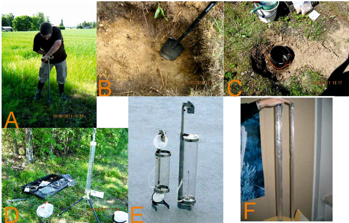
Kuva 10. A: hienoainessedimenttinäytteenottoa käsikairalla, B: moreeninäytteenottoa lapiolla, C: imeytyskoe imeytysrenkaalla, D: Guelphin permeometri, E: vesilimnosnäytteennoudin (Kuva Limnos.pl (2010)), F: kertanoudin (Kuva Rintala ja Suokko 2008).
