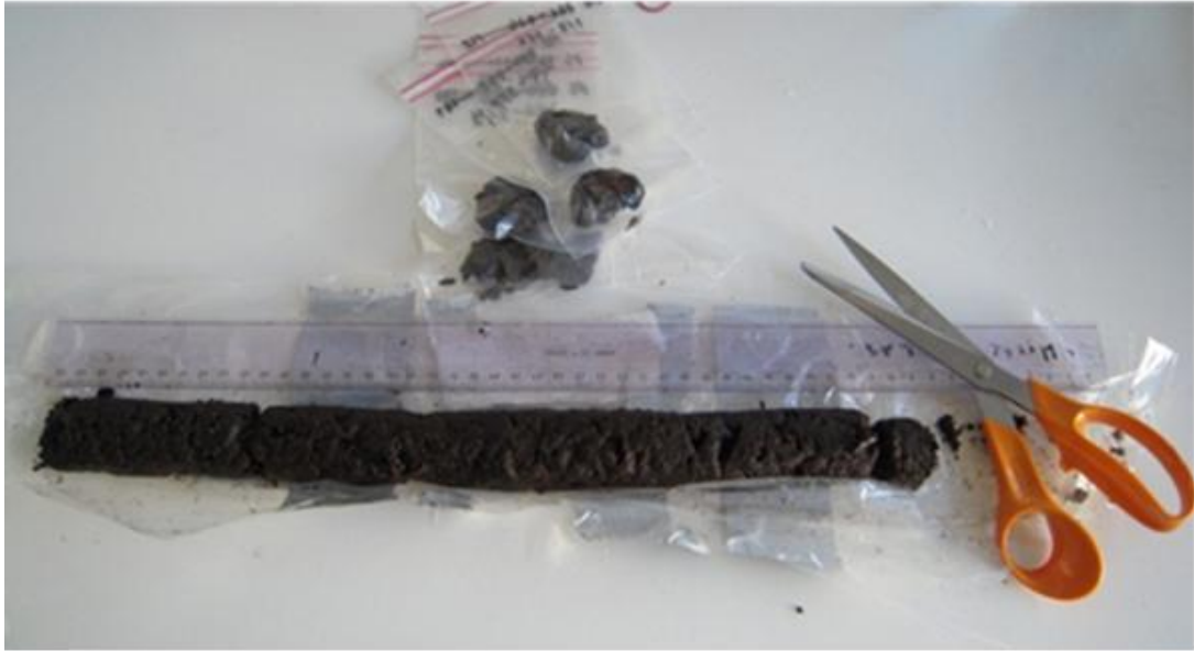
Kuva 7. Turvenäytteen viipalointia laboratoriossa.
