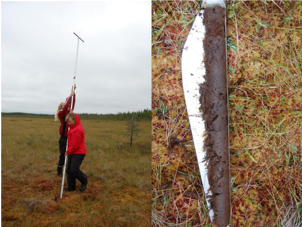
Kuva 6. Vasemmalla näytteenottoa Puohtiinsuolla, oikealla turvenäyte venäläisessä suokairassa.
