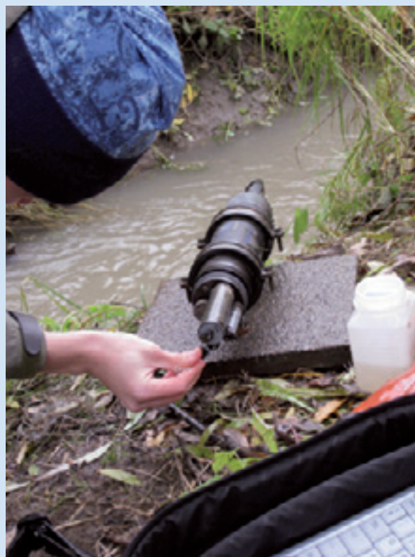
Vedenlaadun automaattisen mittalaitteen puhdistusta puron varressa. TH
