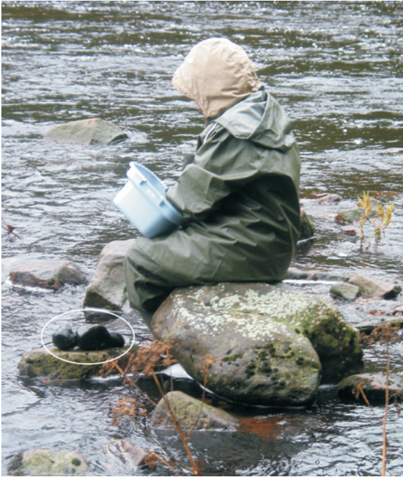
Kuva 7. Näyte kivien harjaaminen piilevänäytettä varten. Harjattavat näytekivet on kerätty näytteenottajan vieressä olevalle kiville.
