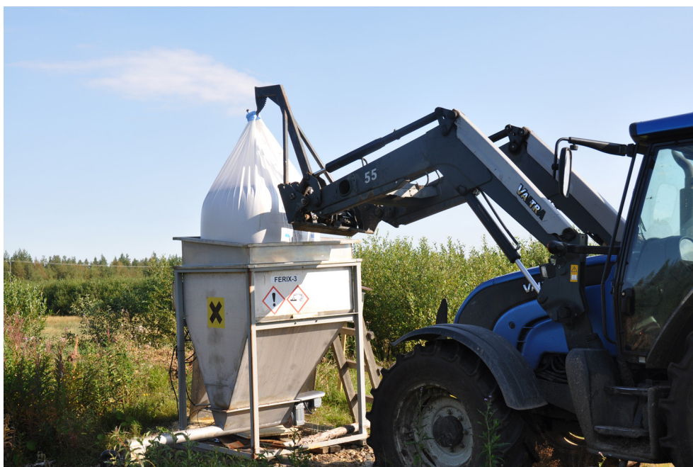
Kuva 8. Navettarimmen kemikaalisiilon täyttö rakeisella ferrisulfaattilla.
