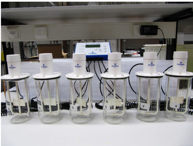
Kuva 9. Laboratoriokokeissa käytössä ollut jar-laitteisto Kemira Kemwater, Flocculator 2000.
