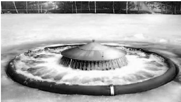
Kuva 6.6. Visiox-ilmastin ja sen toimintaperiaate (Vesi-Eko Oy 2006).
