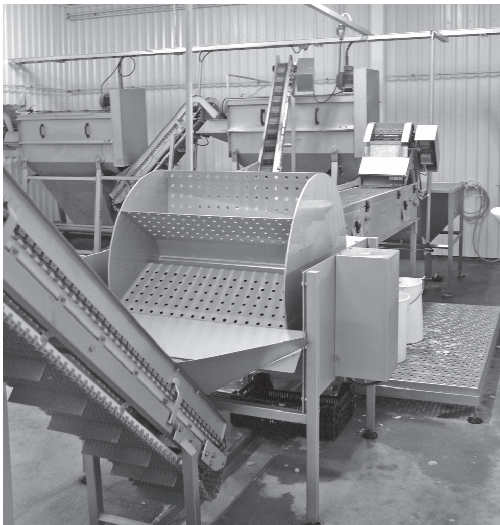
Kuva 1. Kaksivaiheinen perunankuorintalinja. Kuivakuorinta hionta- ja veitsikoneilla. T:mi. Lasse Kiviranta, Virttaa. Kuva: Mikko Anttalainen
