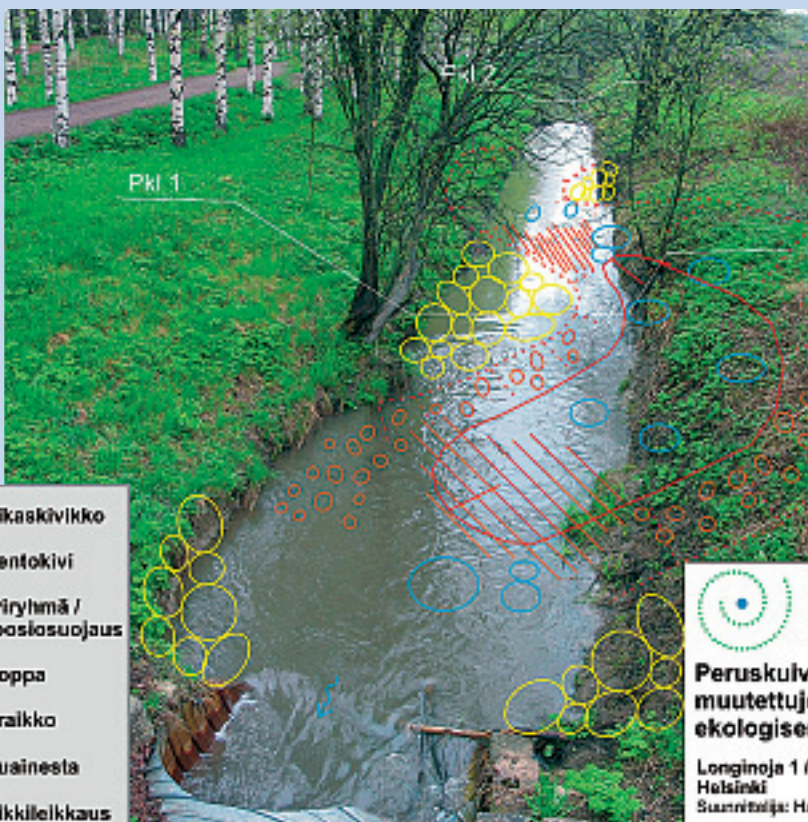
Kuva 19. Longinojan yksityiskohtainen kunnostussuunnitelma piirrettynä suoristetuasta uomasta otetun kuvan päälle. Kuva ja suunnitelma Harri Aulaskari, Uudenmaan ympäristökeskus.
