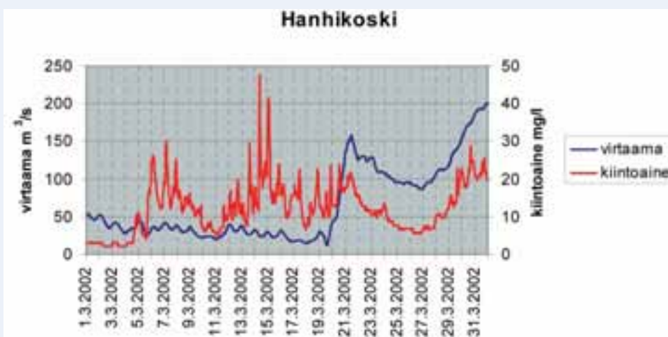
Kuva 44. Virtaama ( m^3/s ) ja kiintoainepitoisuus (mg/l) Hanhikoskella maaliskuussa 2002 automaattimittauksen mukaan.
