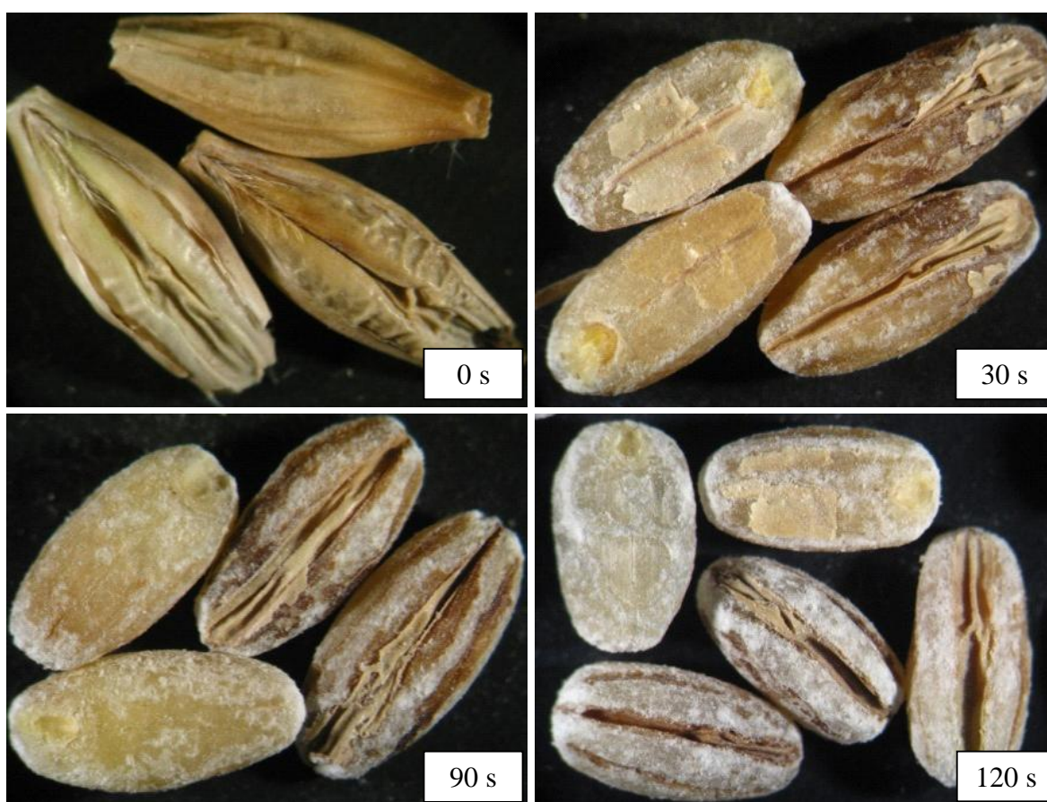
Kuva 18. Stereomikroskoopin 12-kertaisella suurennoksella otetussa kuvassa ylhäältä vasemmalta: Beetaglukaanirikkaan lajikkeen D hiomaton jyvä sekä 30 s, 90 s ja 120 s ajan hiotut jyvät.
