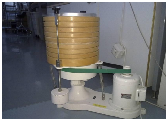
Kuva 8. Seulasarja ravistelulaitteessa, suurisilmäisin seula päällimmäisenä ja umpipohja alinna. Kuva: VTT.
