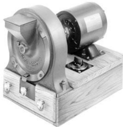
Kuva 6. Ohran kuorintalaite. Kuva: Seedburo Equipment Co. (2012).
