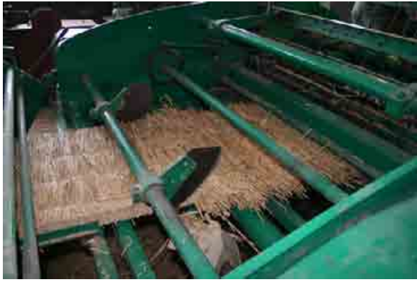
Berger –levyn tekoa Virossa Orissaaren lähellä Roomaja OÜ:ssä. Ylijäämämateriaali poltetaan lämpölaitoksessa. Kuva: Eija Hagelberg
