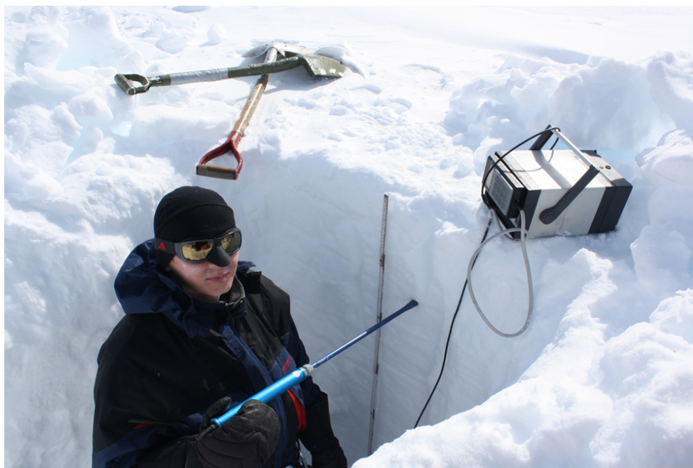
Figure 3.2: Juho Vehviläinen using the snow fork.
