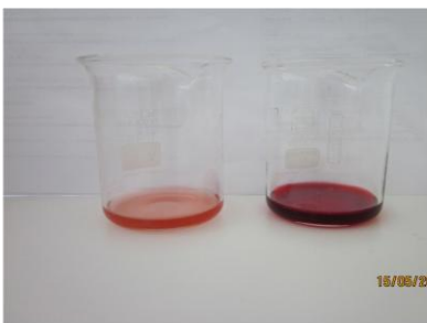
Kuva 21. vasemmalla puolukkamehu värinpoiston jälkeen ja oikealla mehu ilman värinpoistoa
