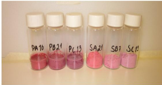
Kuva 7. Vasemmalla kuvassa ovat (P) pakkaskuivatut ja oikealla (S) sumutuskuivatut näytteet .
