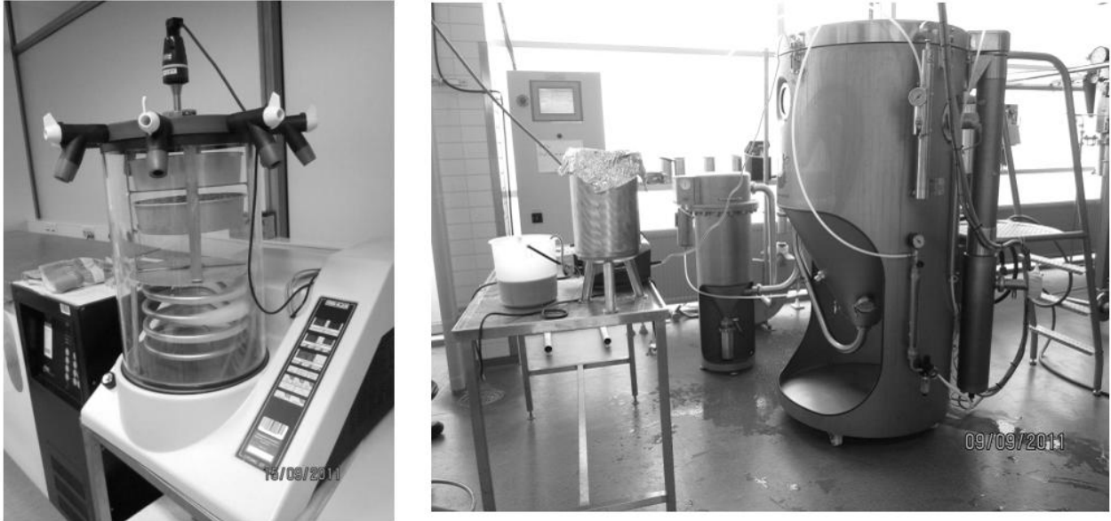
Kuva 5. Vasemmalla kuvassa pakkaskuivain ja oikealla sumutuskuivain. Molemmissa kuvissa on puolukkamehujen kuivaus käynnissä (Kuvat: Terhi Suihkonen).
