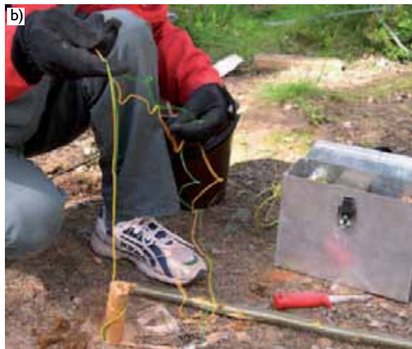
Kuva 9. Räjätysseisminen luotaus. a) geofoni; b) panostus (Suomen ympäristökeskus).
