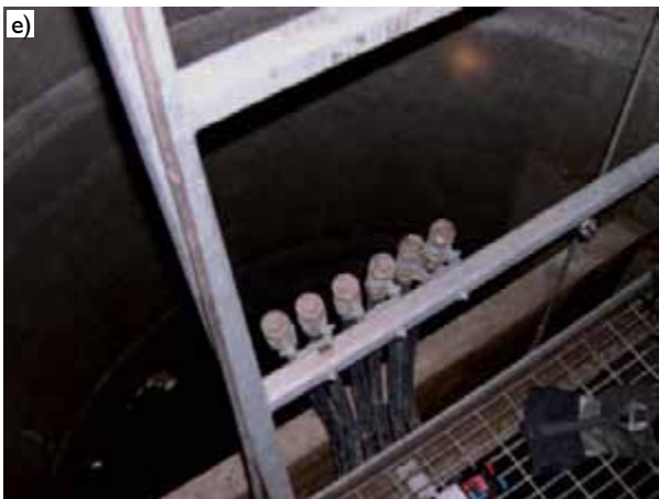
Kuva 36. Säätkäivosta tapahtuvan näytteenoton varusteet ja olosuhteet: a) happinaamari; b) happi- ja turvalaitteet; c) köysivarmistus; d) kaivon ylätasanne; e) reaktiivisesta materiaalista kaivoon johdettujen letkujen päät näytteenottotasanteelta (-15 m); f) näkymä näytteenottotasanteelta ylöspäin (Suomen ympäristökeskus).
