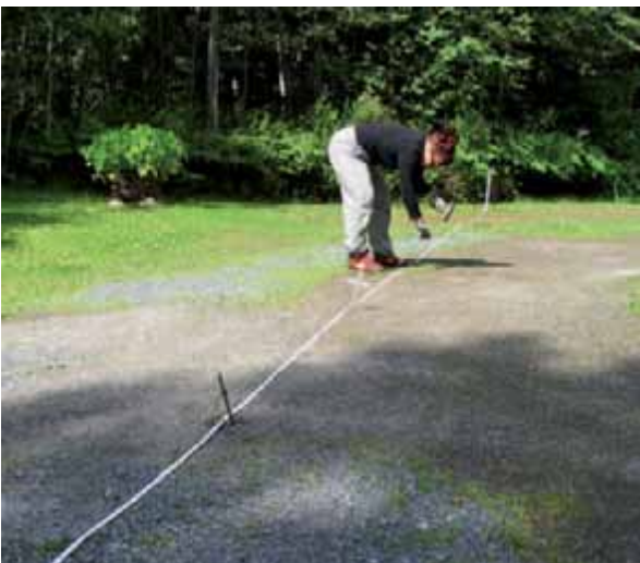
Kuva 10. Sähköisen vastusluotauksen linja (Suomen ympäristökeskus).
