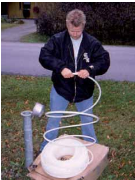
Kuva 15. Waterra-pohjaventtiilin asennus HDPE-letkuun (Suomen ympäristökeskus).
