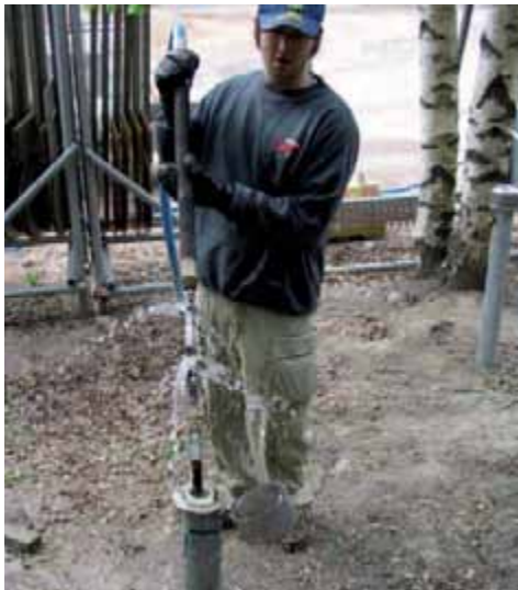
Kuva 14. Vedenjohtavuusmittausta packer-laitteistolla (Suomen ympäristökeskus).
