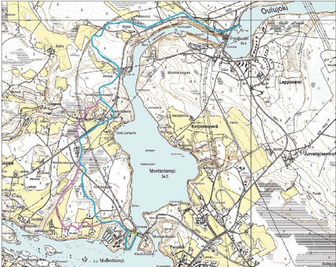
Kuva 32. Montan ja Pyhäkosken voimalaitokset yhdistävä pitkä ohitusuoma, jossa itäinen sininen linjauks on päävaihtoehto, punainen lisävaihtoehto. Montan ensimmäinen ohitusuoma muodostaisi alaosaan. Uoman pituudeksi tulisi yhteensä 7 kilometriä tai yli 10 kilometriä, jos yläosa tehdään mutkitteluvaana. Näin saataisiin runsaasti uusia lisääntymisalueita.
