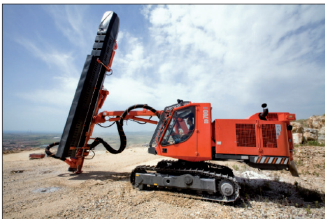
Kuva 5. Porausvaunut ovat usein tela-alustaisia. Pöly- ja melupäästöjä voidaan vähentää erillisillä lisälaitteilla. (Kuva Sandvik 2010)
