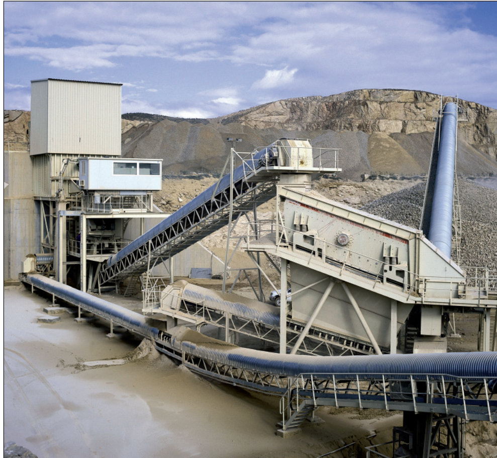
Kuva II. Kokonaan koteloitu seula. (Kuva Metso 2002)
