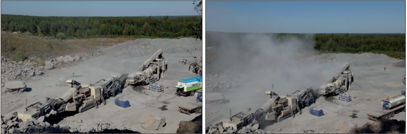
Kuva 12. Vedellä tehtävän pölynsidonnan näkyvä vaikutus murskausprosessin pölypäästöön. (Kuva Metso 2010)
