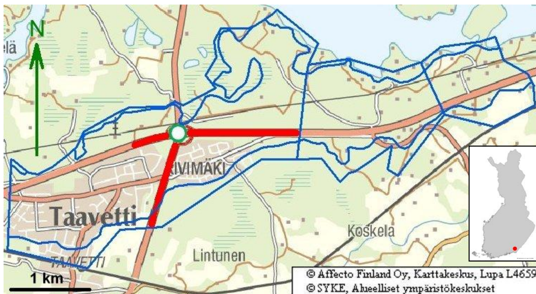
Kuva 5. Taavetin pohjavesialue (rajattu sinisellä) ja tieosuudet, joilla käytetään kaliumformiaattia liukkaudentorjunnassa (merkitty punaisella).
