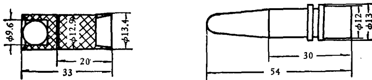
图7 轻气炮发射的圆球和旋成体模型结构示意图
