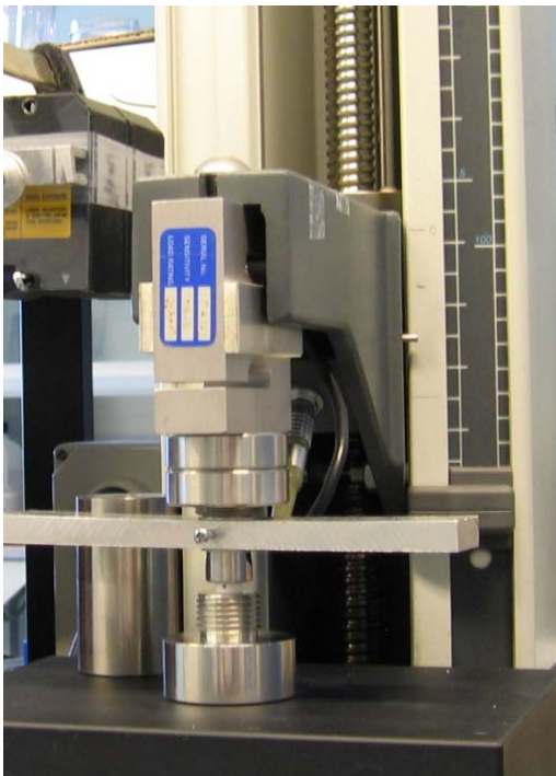
Kuva 6. Youngin moduulin määrittämiseen käytetty mittauslaitteisto.
