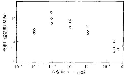
图1 冰的极限压缩强度与应变率的关系
