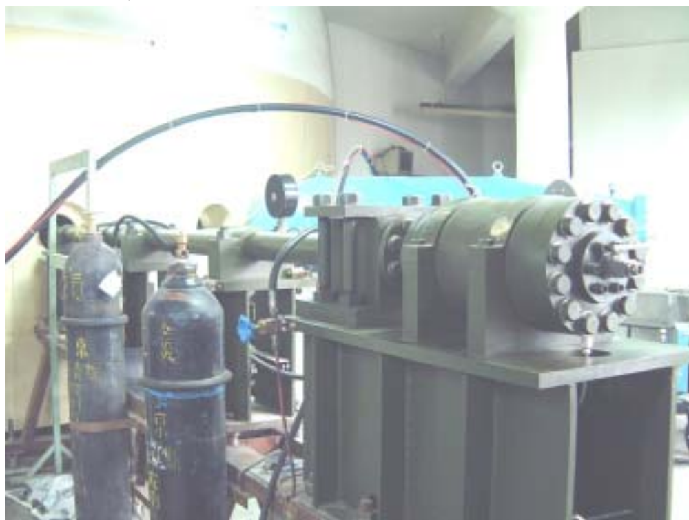
图 2 加速撞击体的低速气炮
