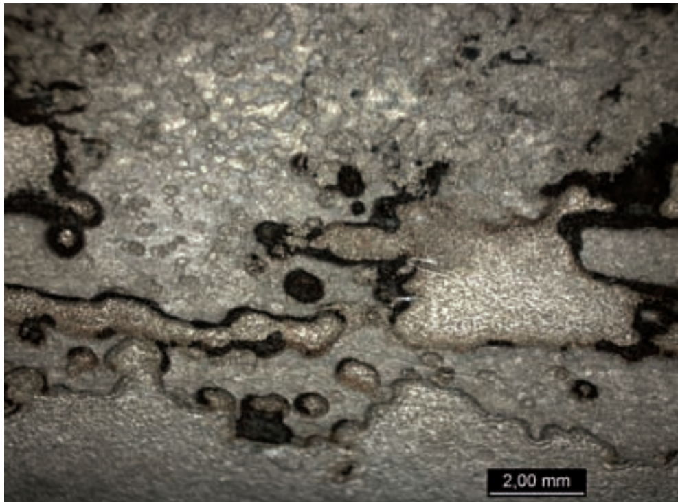
Kuva 46. Stereomikroskooppikuva näyttötangon 2-1 alaosan voimakkaasta läikittäisestä syöpymisestä 12 kk:n altistuksen jälkeen mesofiilisessa reaktorissa 1.
