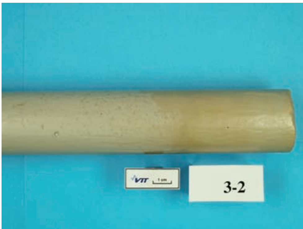
Kuva 50. Termofilireaktorissa 6 kk ollut betoninäytetanko 3-2.
