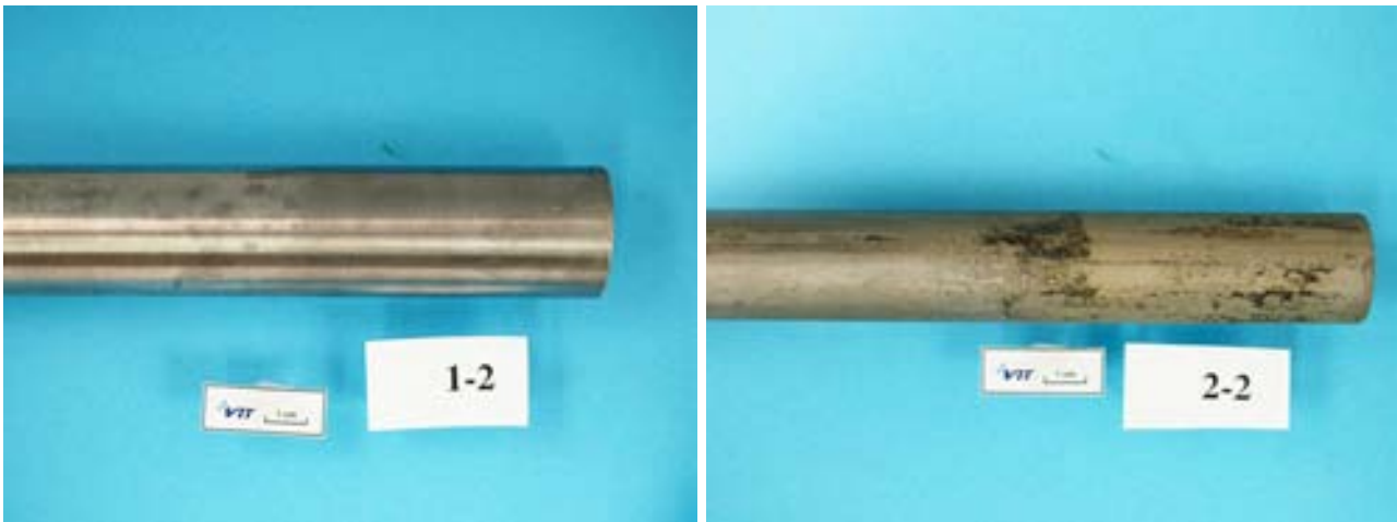
Kuva 23. A) Näytekappale 1-2 (haponkestävä ruostumaton teräs) ja B) 2-2 (hiiliteräs) peittauksen jälkeen, koeaika 12 kk termofilireaktorissa.
