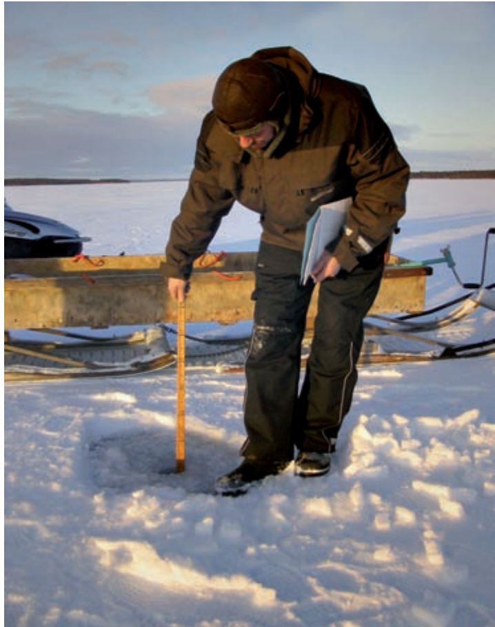
Jäänpaksuuden mittausta Inarijärven Nellimin Paksuvuonon ulappahavaintopaikalla (kuva Erno Salonen).
