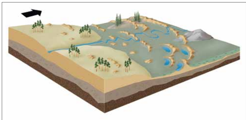
Kuva 27. Deltan, jääjärvikerrostuman tai rantakerrostuman yhteyteen kehittynyt dyyrialue. Dyyneiden väliset alueet ovat soistuneet. Dyynit ovat vaeltaneet paikoin moreeniin ja kallioalueen päälle. Nuoli osoittaa vallitsevan tuulen suunnan. Piirros: H. Kutvonen, GTK.
