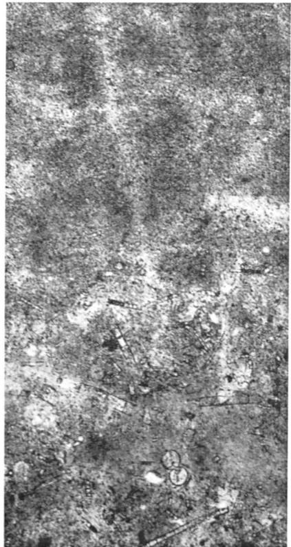
ABB. 9. Etwa 150-fache Vergrößerung eines Dünnschliffes, von sulfidabgelager- tem Ton.
