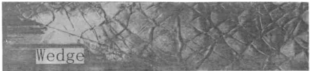
图 9 P_0 = 16 \text{ kPa} , \alpha = 19.30^\circ , Mach 反射的胞格结构烟迹记录( 2\text{H}_2 + \text{O}_2 + \text{Ar} , \lambda = 1.45 \mu\text{m} , M_{\text{c}j} = 5.12 ), 三波点迹线在楔块顶点开始形成
