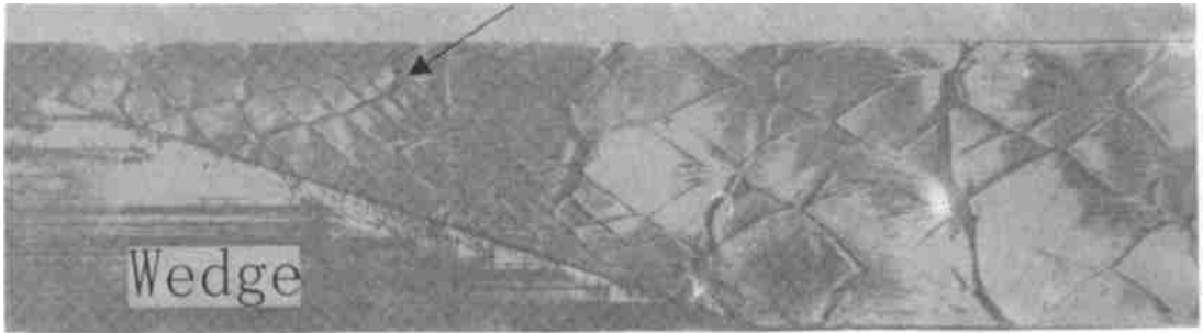
图 8 P_0 = 16 \text{ kPa} , \alpha = 19.30^\circ , Mach 反射的胞格结构烟迹记录( 2\text{H}_2 + \text{O}_2 + \text{Ar} , \lambda = 1.45 \mu\text{m} , M_{\text{c}j} = 5.12 ), 三波点迹线在楔块斜面上开始形成
