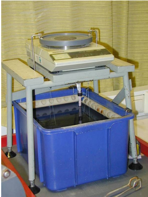
Kuva 4.4: Samalla vaa'alla voidaan punnita näyte sekä ilmassa että vedessä. S. Vuoriainen, GTK.
