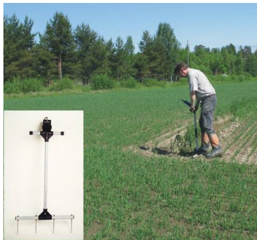
Kuva 6.6: Maaperän pinta-kerroksen (0-0.3 m) johtokyvyn selvittämiseksi on GTK:ssa rakennettu ns. johtavuusharava, jonka anturin muodostaa Wenner-elektrodijärjestelmä. (S. Vuoriainen, GTK)
