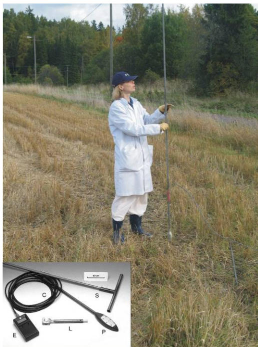
Kuva 6.5: Maaperän johtokyvyn selvittämiseksi on GTK:ssa rakennettu Risto Purasen suunnittelema ominaisvastus-lämpötilaluotain, joka soveltuu pehmeiden maalajien, kuten savi-, turve- ja lieju mittauksiin. Tämän luotaimen avulla saadaan soiden ja savikoiden ominaisvastus ja lämpötila määritettyä maastossa n. 10 metrin syvyyteen saakka. (H. Säätuvuori /GTK)
