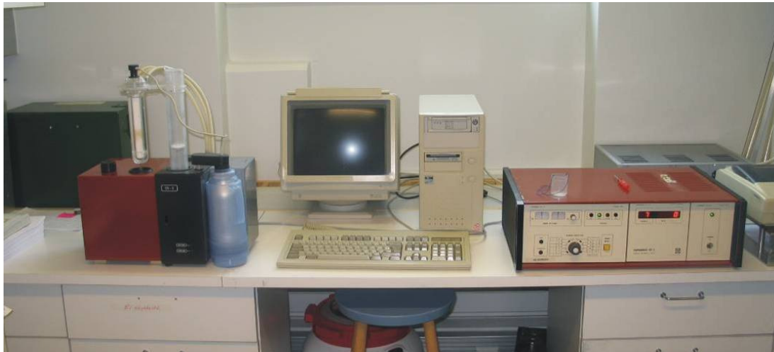
Kuva 5.13: GTK:n Geofysiikan laboratorion KLY-3S Kappabridge ja CS-3 Temperature Control Unit, jolla mitataan suskeptibiliteetin lämpötilariippuvuutta alhaisessa kentässä. (S.Vuoriainen, GTK)
