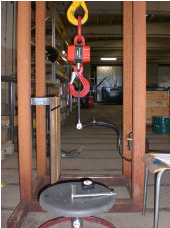
Kuva 22. Piikkien kuormituskokeessa käytetty koejärjestely.
