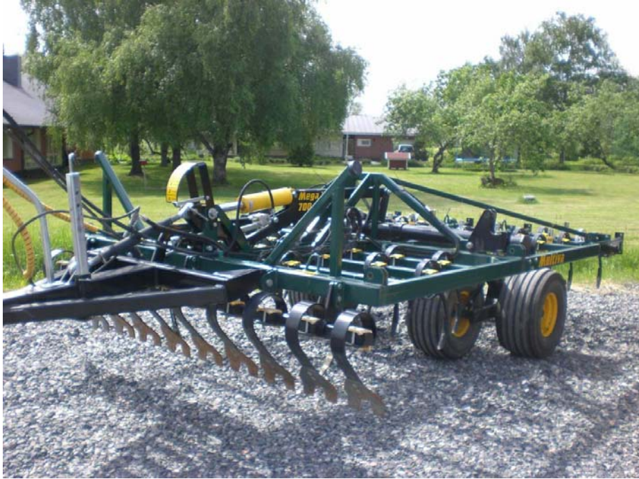
Kuva 11. Kokeissa käytetty Multiva Mega XL 700 -äkeen keskilohko.
