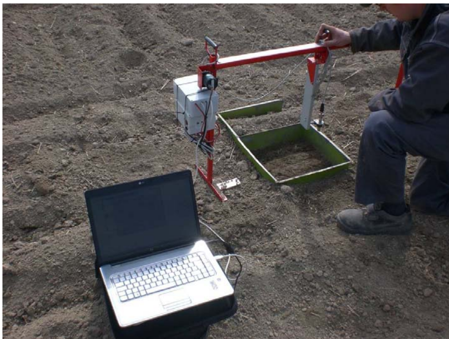
Kuva 15. Kokeessa käytetty mittauskelkka ja tiedonkeruussa käytetty tietokone.
