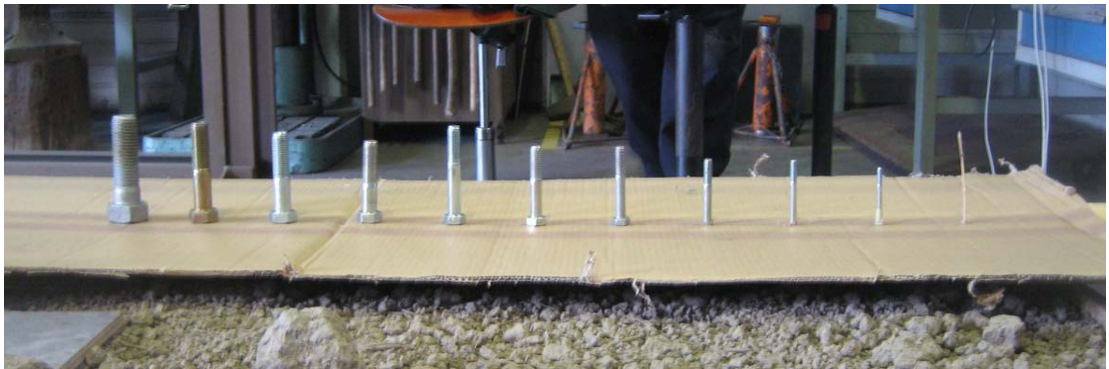
Kuva 7. Säterin tutkimuksessaan ultraääniantureille tekemän peiliheijastustestin koeasettelu (Säteri 2008).
