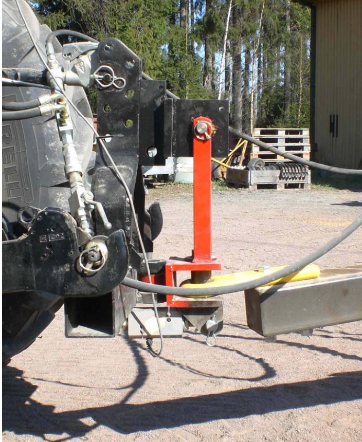
Kuva 12. Kokeissa käytetty vetokarttu ja voima-anturi
