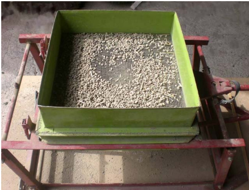
Kuva 20. Testissä käytetty seulontalaite ja 4 mm seula.
