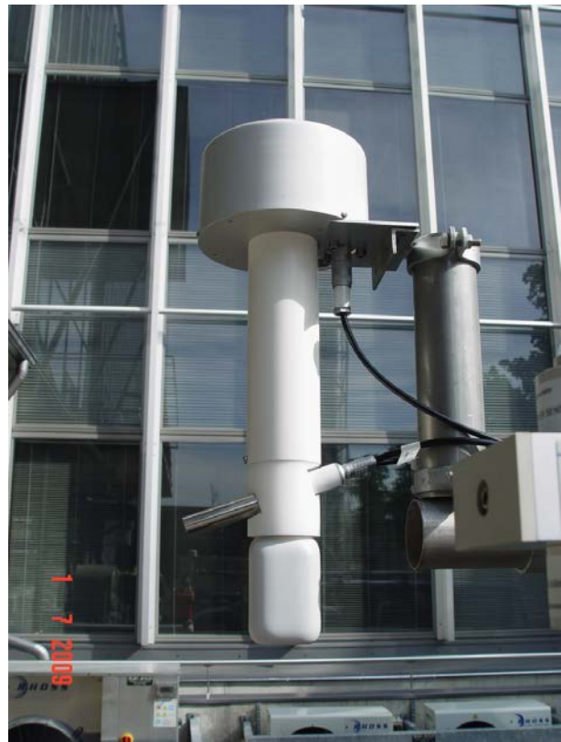
Kuva 12: Tutkimusprojektissa käytetty tuulettettu lämpömittari (Kuva A. Drebs).
