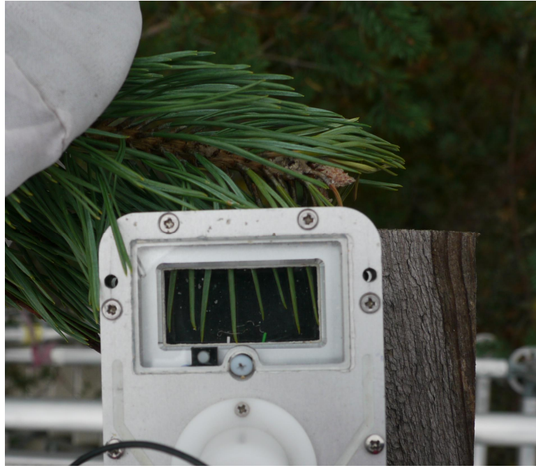
Kuva 3. Neulaset pujotettiin neulaskyvettiin tiivisteeseen tehtyjen reikien läpi. Verso 3 mitattavana 22.9.2010.
