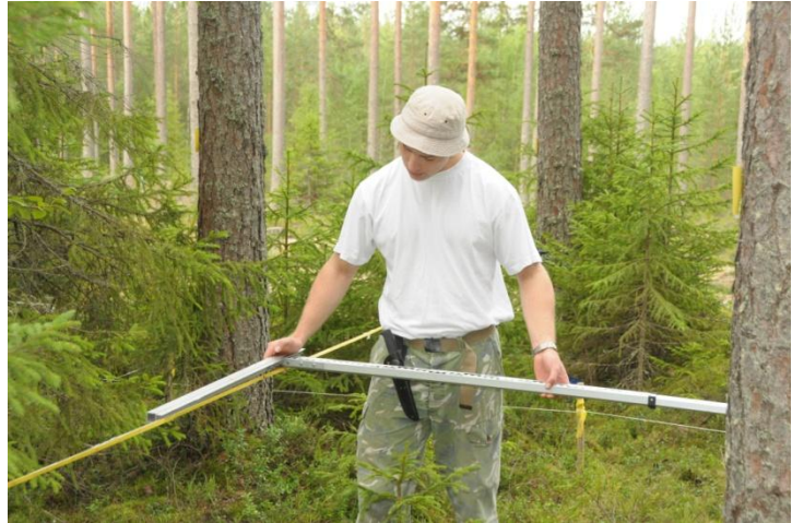
Kuva 2. Puiden paikannus vaijerin ja suorakulman avulla (vasen). Vaijerin alku- (x_1, y_1, z_1) ja loppupisteet (x_2, y_2, z_2) paikannettiin, ja etäisyydet a ja b mitattiin käyttäen tarkoitusta varten rakennettua suorakulmaa (oi-kea).
