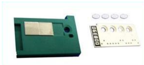
Kuva 9. TL-dosimetrin rakenne. Vasemmalla slidekotelo, oikealla ylhäällä neljä TL-kidettä ja niiden alapuolella slide, jossa näkyy tunnistusnumero [36].
