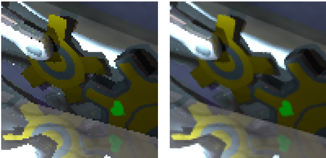
Kuva 6.4: Vasemmalla säteenseuraja ilman antialiasointia. Oikealla antialiasoinnilla, 16 näytettä kuvapistettä kohti. Laskenta-aika noin 2 minuuttia ja 13 sekuntia.
