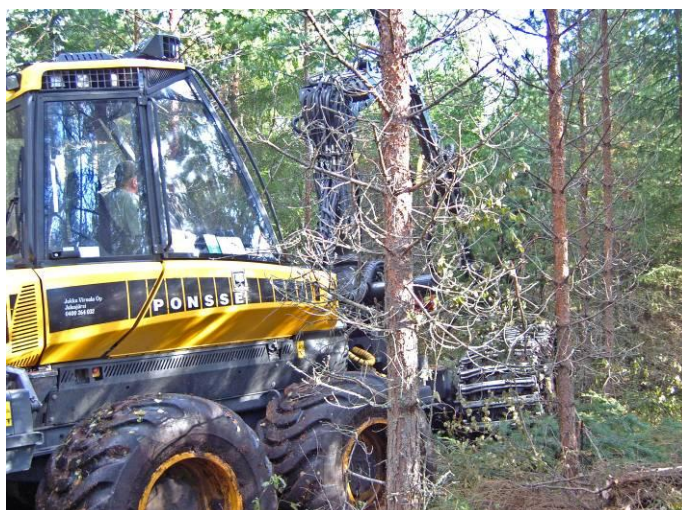
Kuva 1. Hakkuu tehtiin Ponsse Wisent Dual -koneella, jossa oli EH25 -joukkokäsittelykoura (kuva: Jussi Laurila).
