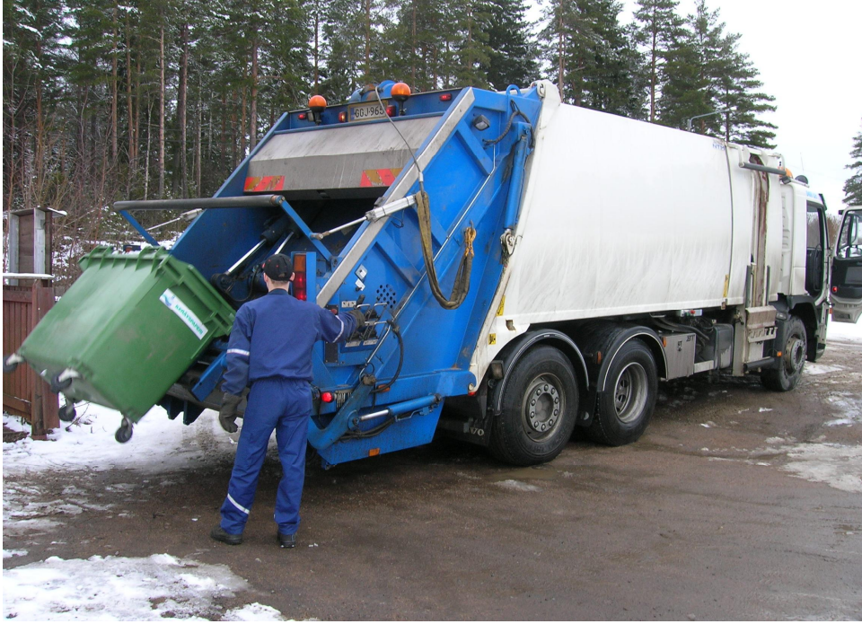
Kuva 7. Pakkaaja-auto tyhjentämässä 600 litran muoviastiaa 17.3.2008.
