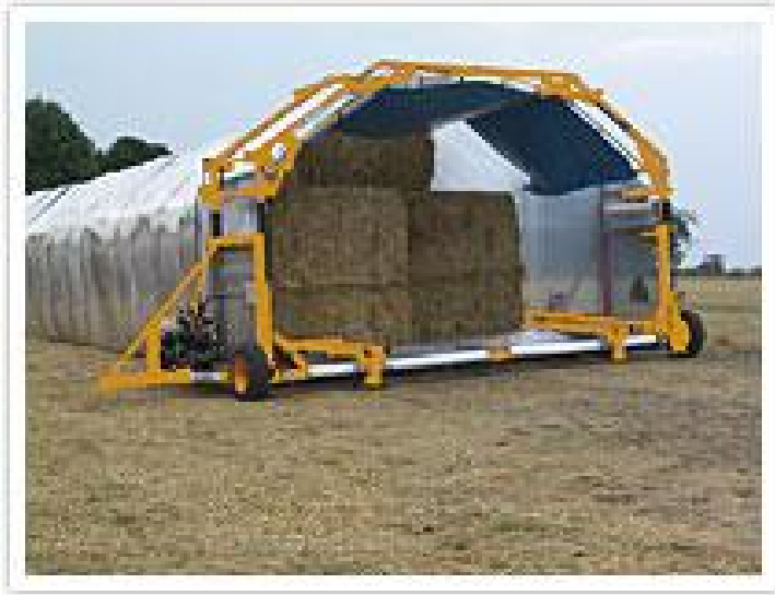
Kuva 8. Pomi Wrap 5-paalien varastointikone (Anon. 2008).
