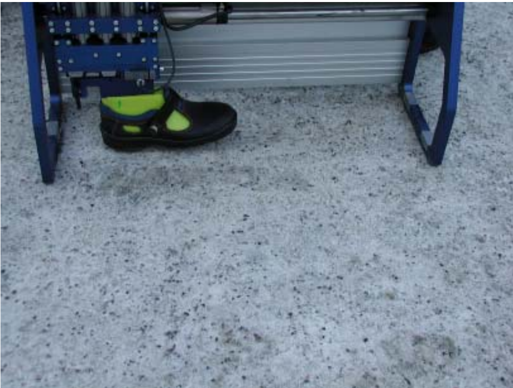
Kuva 8. Hyvin hiekoitetulla tallaantuneella lumella oli hyvä pito jalkineesta riippumatta: liukkaan jalkineen kitkakerroin oli 0,39 ja pitävän 0,42.
