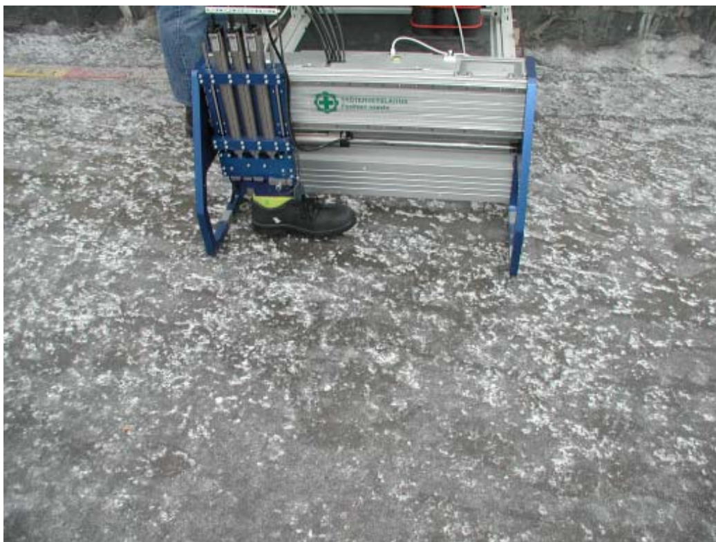
Kuva 5. Mitattaessa jätää ( T=-6^{\circ}\text{C} ), jolla oli ohut kerros vastasatanutta lunta, saatiin kitka-arvoksi 0,12 liukkaalle ja 0,15 pitävälle jalkineelle.
