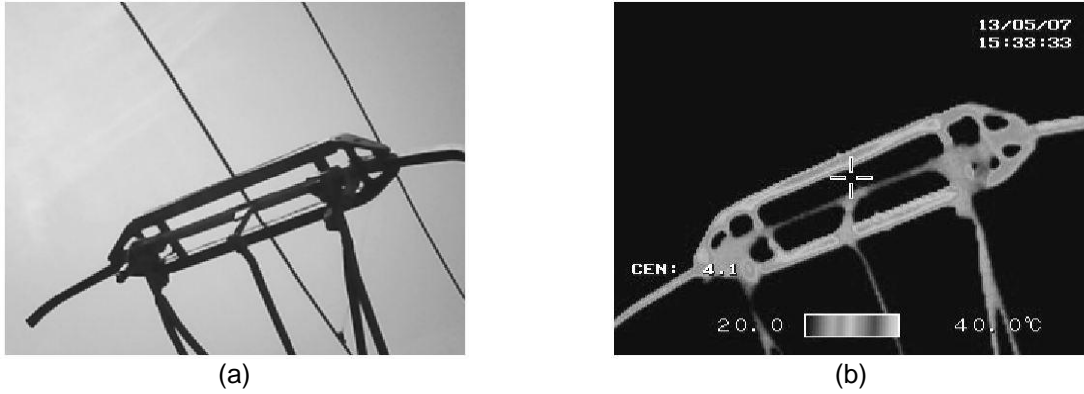
Şekil 5. Termal kameradan alınan pantograf katener sistemin gri seviyeli görüntüleri (a) Normal görüntü (b) Termal görüntü
