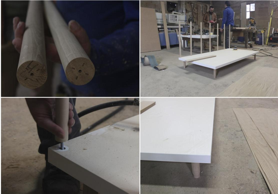
**Figura 49: Algumas imagens de detalhe dos pernos torneados e do seu funcionamento**
