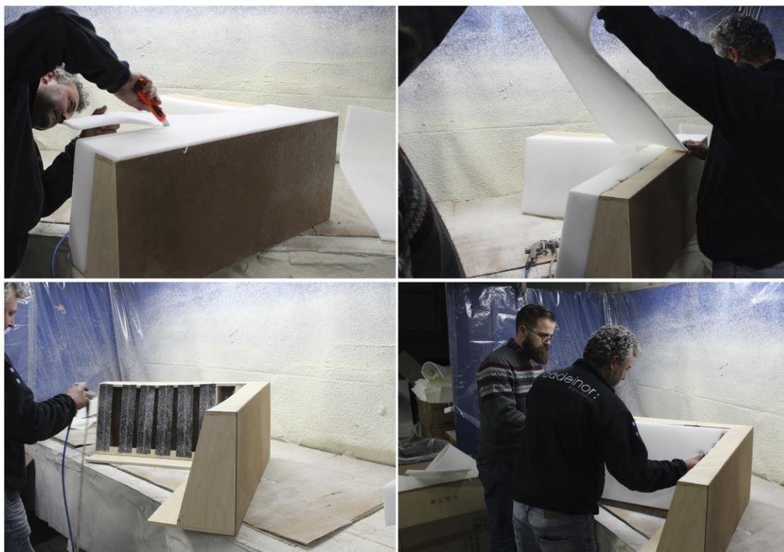
**Figura 57: Corte e colagem das espumas nos cascos de madeira (encosto e assento)**
