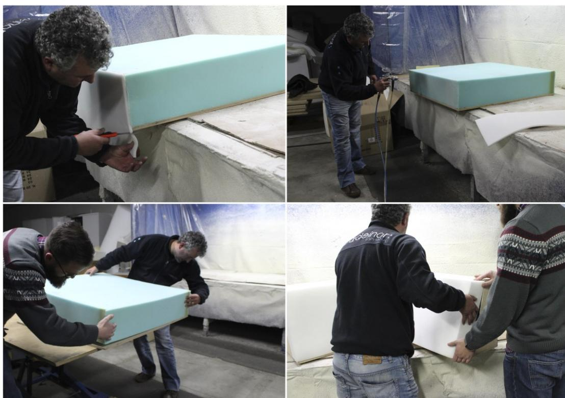
**Figura 58: Corte e colagem das espumas nos cascos de madeira (encosto e assento)**
