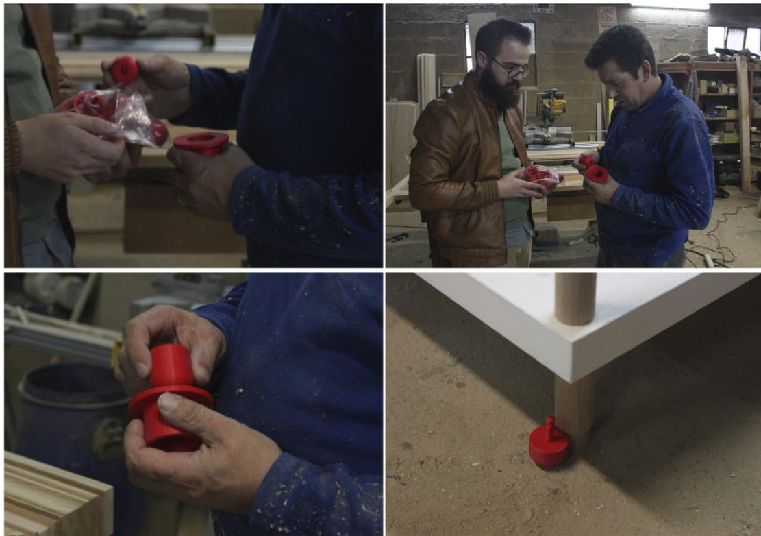
Figura 46: Imagens com detalhes das peças impressas em PLA para introduzir nas partes constituintes do módulo
