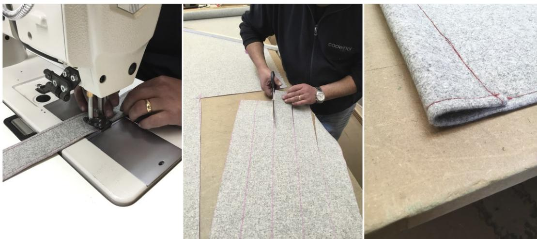
**Figura 65: Fases do processo de execução do tecido para a costa**
