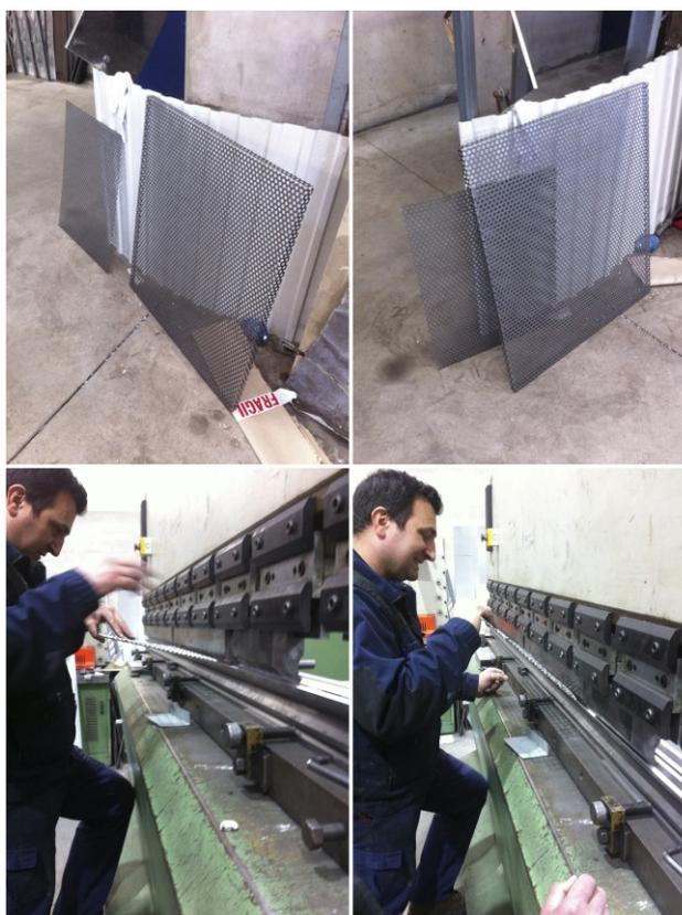
**Figura 66: Quinagem das chapas microperfuradas a serem introduzidas nos pernos e armário do protótipo final**
