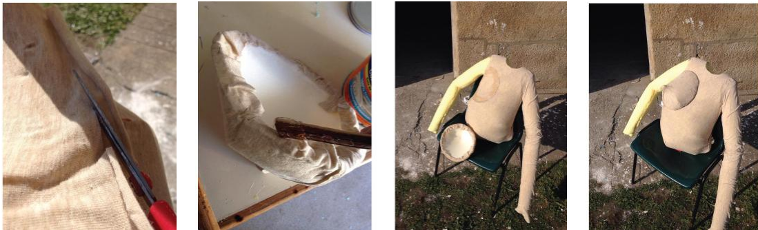
Figura 8: Da esquerda para a direita e cima para baixo: Corte do tecido; Utilização de cola de contacto para a colocar o tecido; Aguardar a preparação da cola; Colagem;
