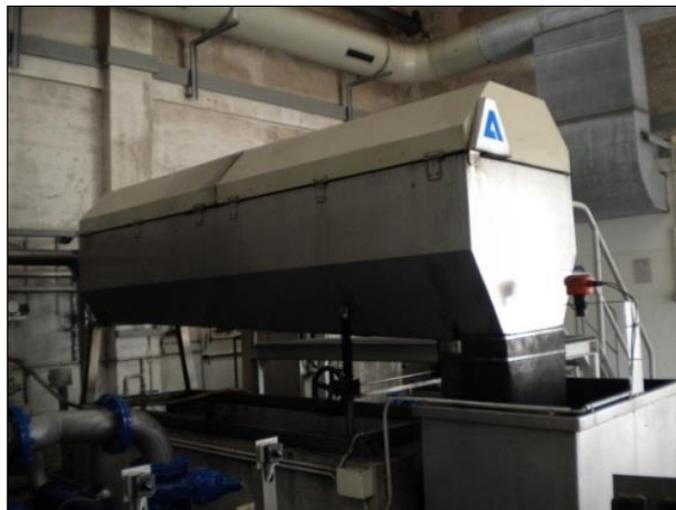
**Figura 2.3** – Tambor rotativo de espessamento de lamas de depuração de ETAR (Fonte: ETAR de Penices).
