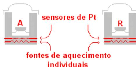
**Figura 4** – DCS de compensação de energia, **A**-Amostra, **R**-Referência [11].
