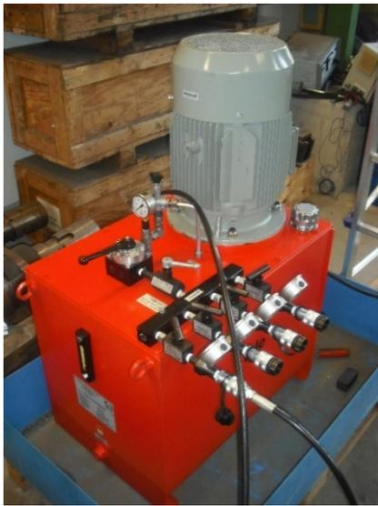
Abbildung 4.17: Hydraulikaggregat
