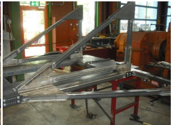
Abbildung 4.8: Außenteil eines Rahmens mit angebauten Dreiecksstützen
