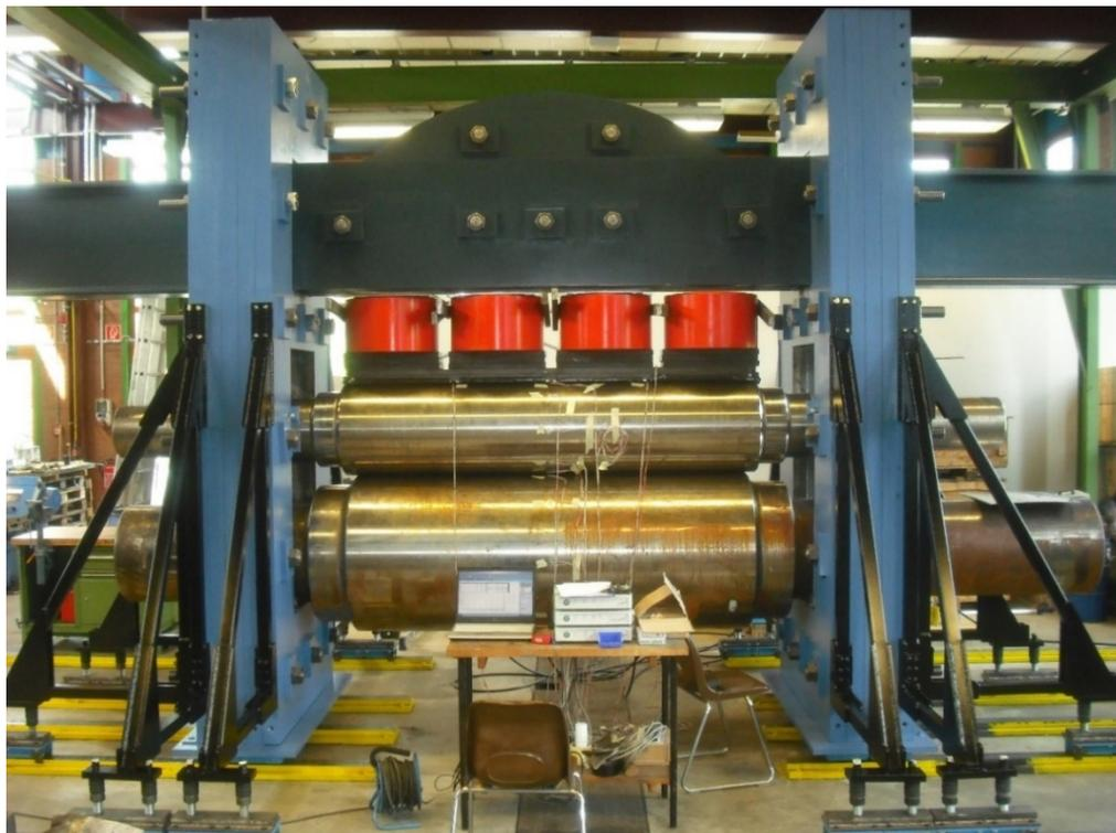
Abbildung 4.12: Prüfstand mit eingebauten Walzen und Schwerlastzylindern
