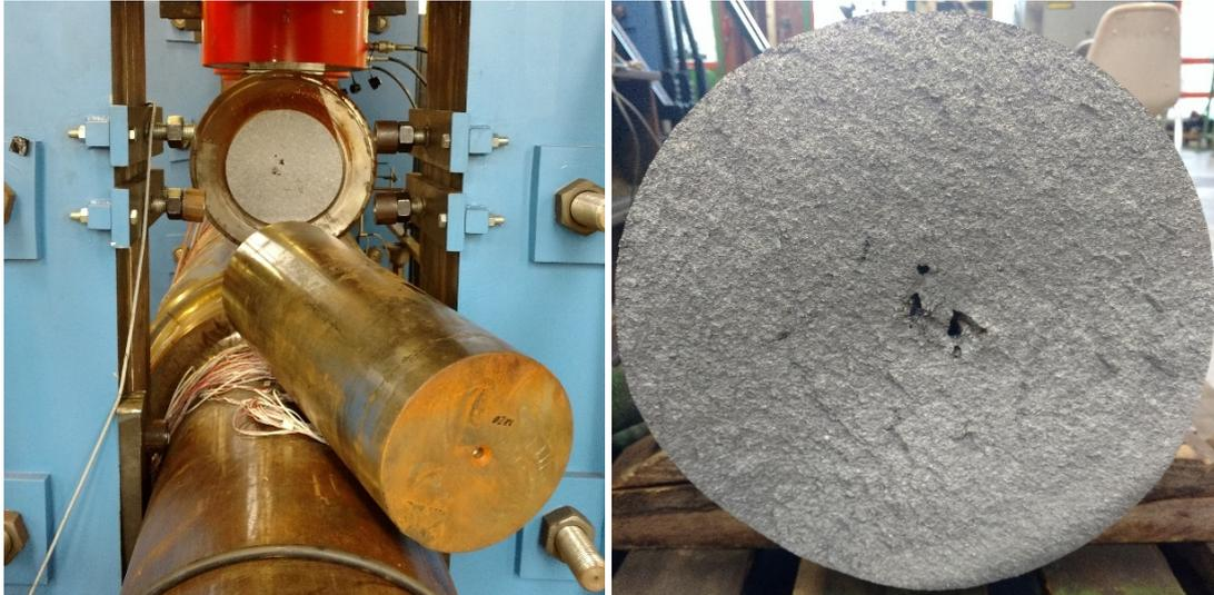
Abbildung 5.17: Abgerissener Zapfen Arbeitswalze HiCr
