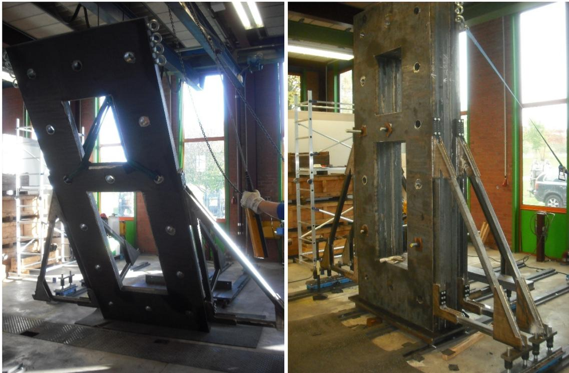
Abbildung 4.9: Aufrichten und Montage der ersten Rahmenteile
