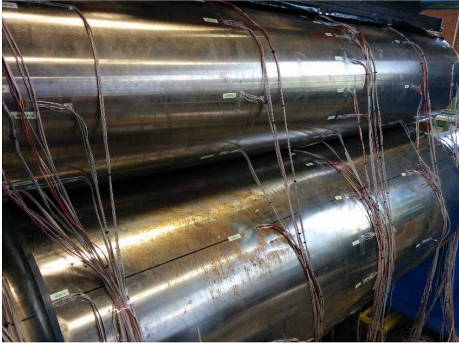
Abbildung 4.15: Applizierte Dehnungsmessstreifen entlang der Walzenballen
