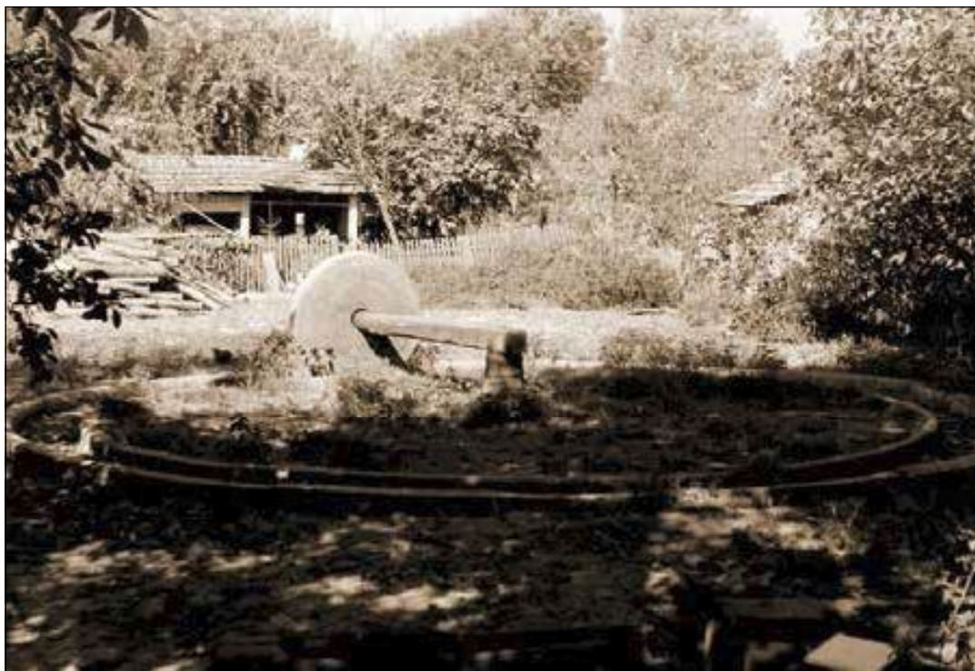
4. ábra: Almatörő sotu az Ormánságban. Az almát az ecet- és borkészítéshez törték vele. Gunda (1956) kutatásai szerint az 1930-as években még működött (fotó: Füzes Endre, 1961, Janus Pannonius Múzeum Néprajzi Osztály fotóarchívuma. Leltári szám: 6925.)
