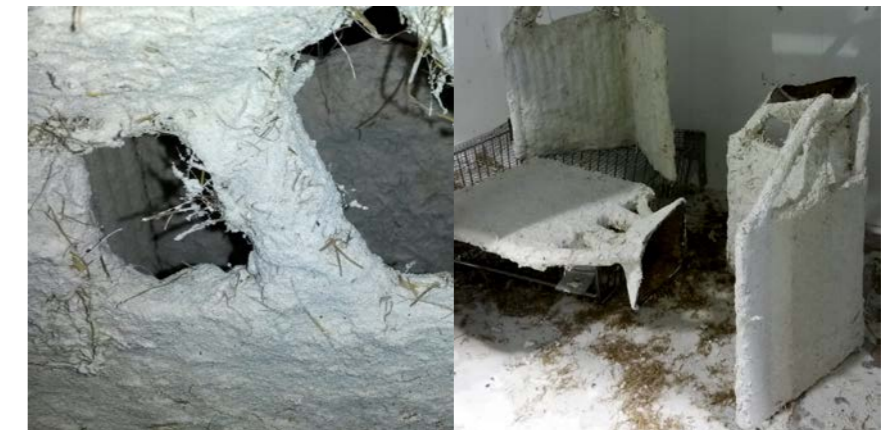
Secado de los moldes de cáscarilla de cerámica
