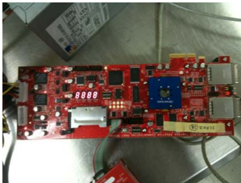
PEACH チップフロアプラン PEACH チップを搭載した PCI-Express テストボード
